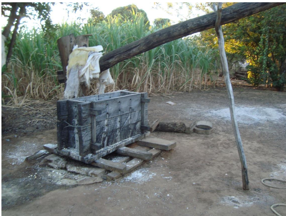
Imagem 8 - Prensa para colocar a massa
