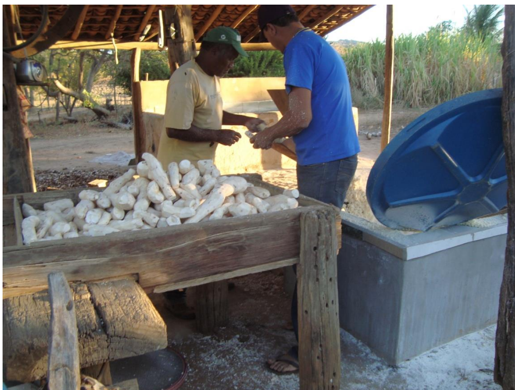
Imagem 12 - Caixa de madeira para colocar a mandioca para ralar
